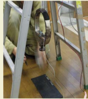
JIS A 6519: 「転倒衝突時の床のかたさ」試験 試験装置の一部(アタッチメント部分[写真])
