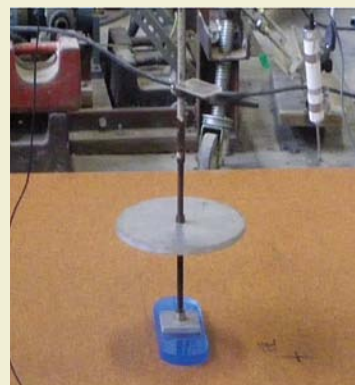
「足元の安定性からみた床のかたさ」試験 試験装置の一部(アタッチメント部分[写真])
